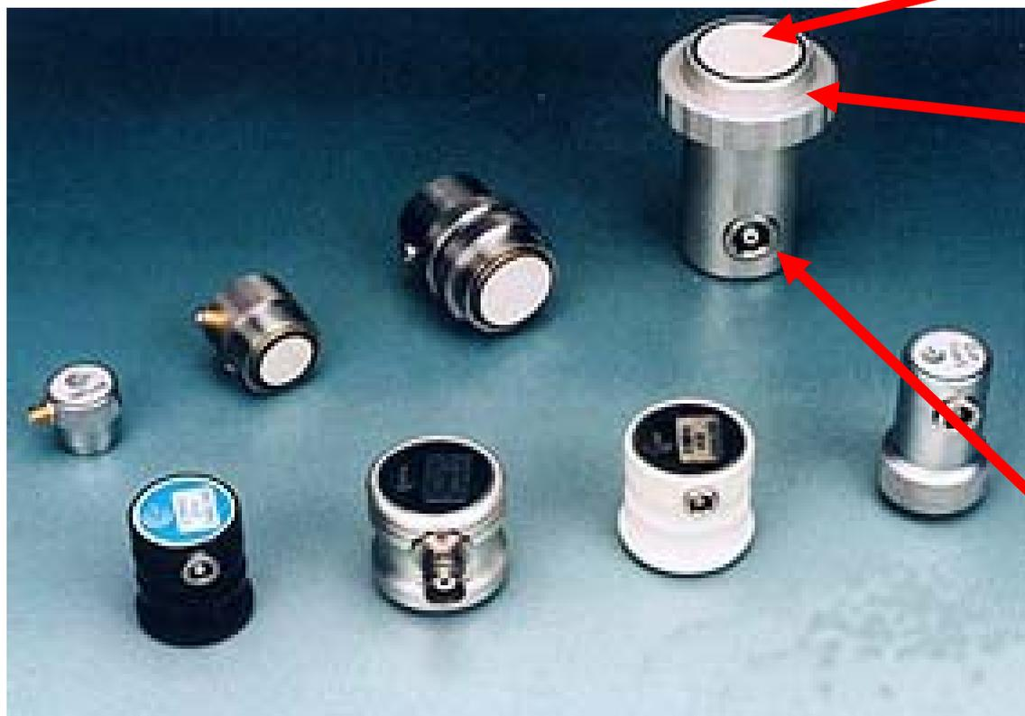
外壳用金属制作，保护膜用硬度很高的耐磨材料制作，防止压电晶片磨损。
