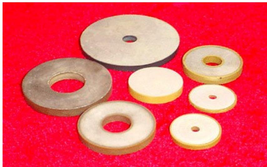
将数百伏的超声电脉冲加到压电晶片上，利用逆压电效应，使晶片发射出持续时间很短的超声振动波。当超声波经被测物反射回到压电晶片时，利用压电效应，将机械振动波转换成同频率的交变电荷和电压。
