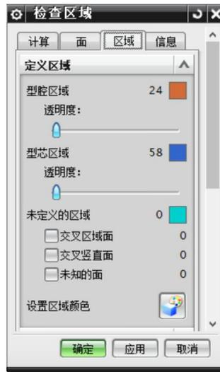
4) 点击“设置区域颜色”图标，型腔区域将自动设置为橙色，型芯区域将自动设置为蓝色。橙色面与蓝色面相交处的线段，称为分型线。
