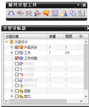
2) 点击分型导航器右上角的“X”，暂时关闭。如果需要显示分型导航器时，再点
