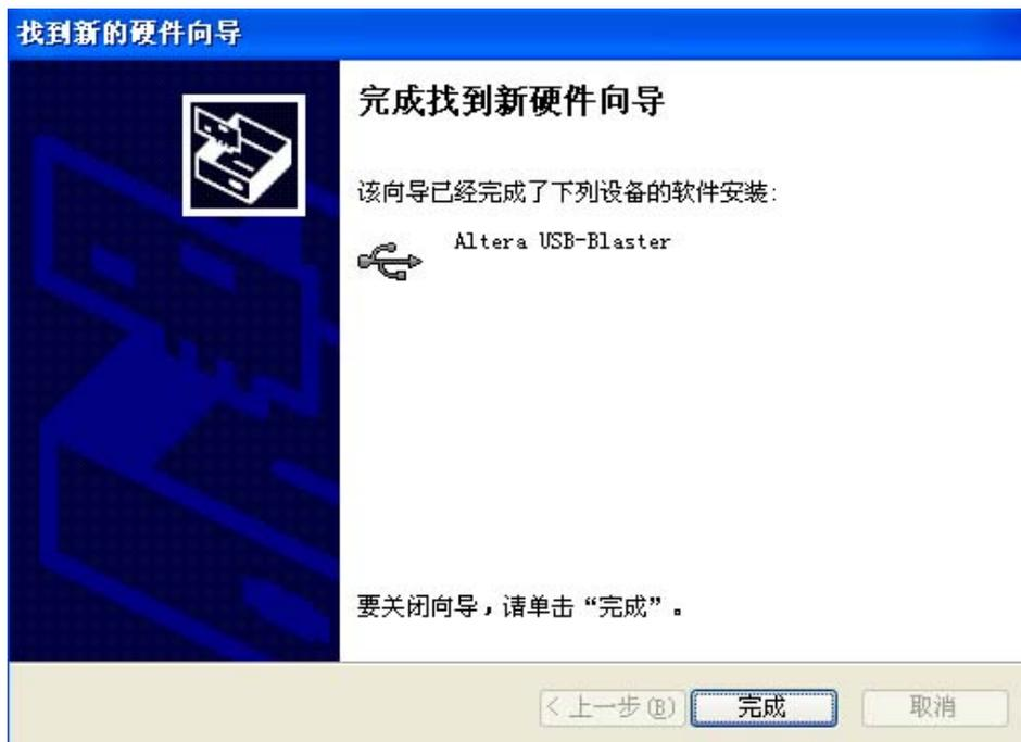
7. 点击“完成”结束驱动的安装。如果您此时进入到设备管理器，您将看到在通用串行总线控制器列表中，出现了 ALTERA USB-Blaster。
