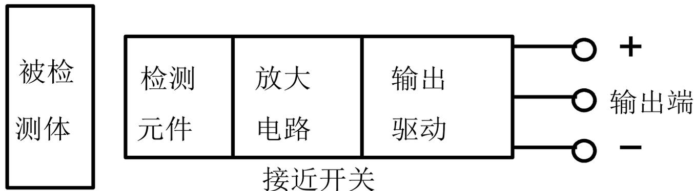
有源型接近开关结构框图
