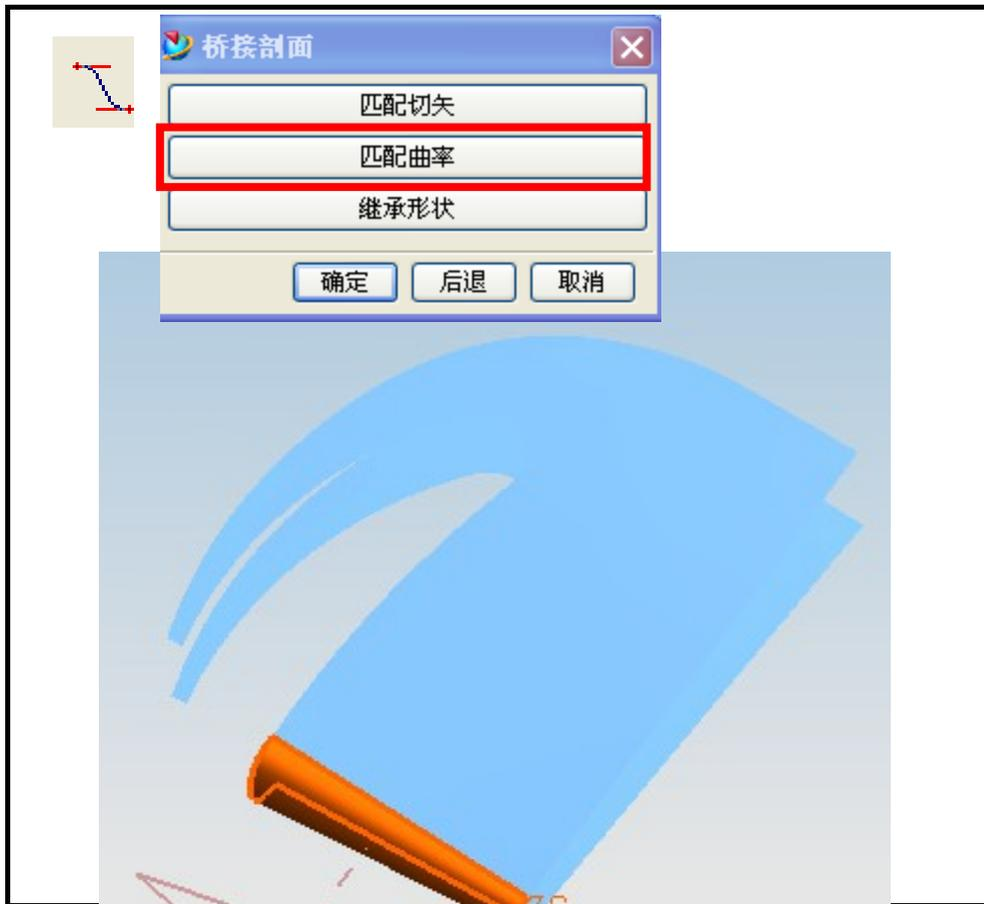
8、使用截面体，圆角 - 桥接 (匹配曲率) 完成两个直纹面的过渡
