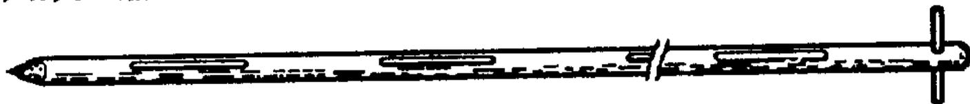
采取车厢、船仓中粮食样品的插管
