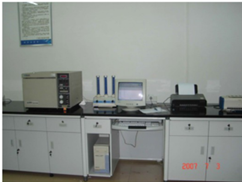
气相色谱仪，带氢火焰离子化检测器
