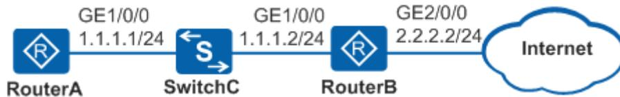
图 1 配置 IPv4 静态路由与静态 BFD 联动组网图
