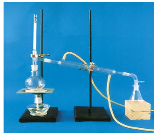
如含有杂质的工业乙醇的蒸馏实验
